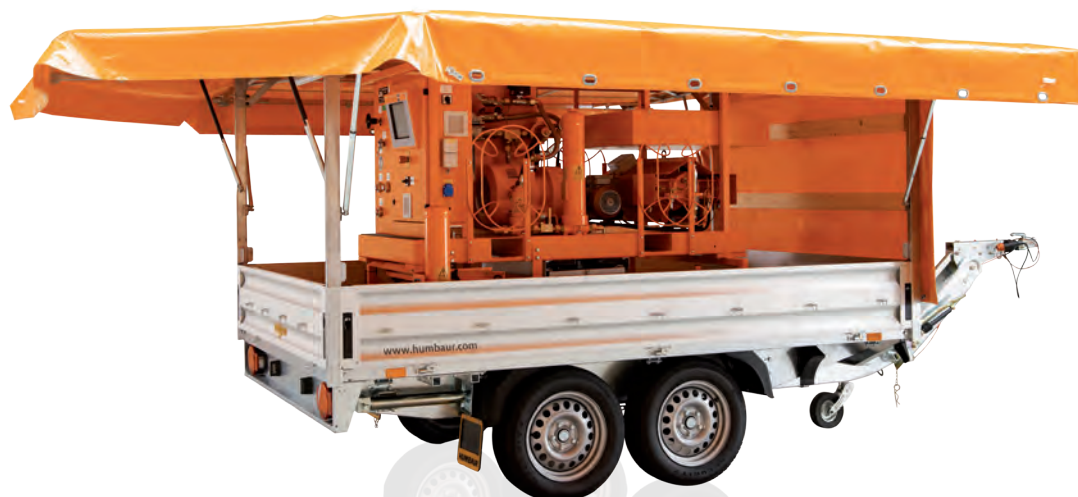
Equipo sobre remolque con bodega, dispositivo de pesaje y 5 botellas de SF 6 B175R11L057
