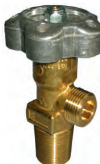
Válvula según DIN 477 no. 6 W21,8 x 1/14" Latón
