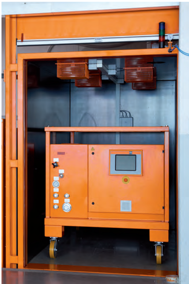
Cámara atmosférica de pruebas con puerta enrollable automática
